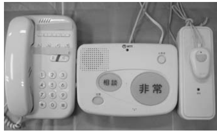
緊急通報装置
